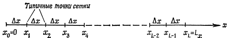
Рис. 1.2. Построение конечно-разностной сетки на отрезке 0 \leq x \leq L_x .
